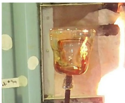
5.熱して吹き込んでを繰り返し成型します
